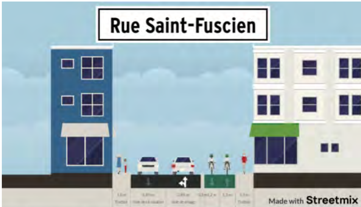
Rue Saint-Fuscien - au niveau du croisement avec les boulevards extérieurs, largeur de 11,5 m. L'attention aux détails fait aussi la cyclabilité : ici la présence de bordures en biseaux augmente la largeur cyclable d'une piste relativement étroite.
